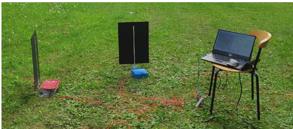
Grafika 10. Model badania wydatku energetycznego symulowanej struktury. Dwie prostokątne płyty połączone z tensometrami zbierają informacje o prędkości wiatru, które są interpretowane przez mikrokontroler, a następnie w zrozumiałym dla jednostki centralnej formacie przesyłanie do programu Rhinoceros Grasshopper, gdzie stanowią dane wejściowe zmiany geometrii modelu.
