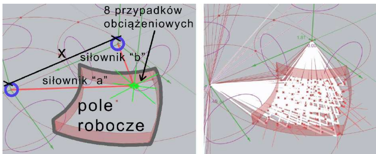
Grafika 26. Schemat układu obciążeń na cele badania jednolitości rozkładu naprężeń.
