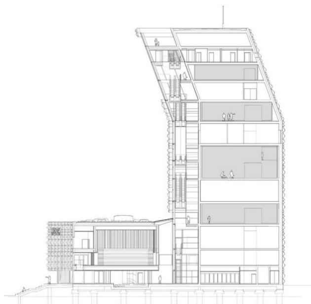
Il. 160. Muzeum Muncha, przekrój (ciemniejszym kolorem oznaczono sale wystawowe, w niższej części strefa wejściowa z audytorium). Źródło: internet
