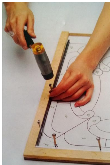
Fot. 78. Mocowanie profili – witraż tradycyjny
