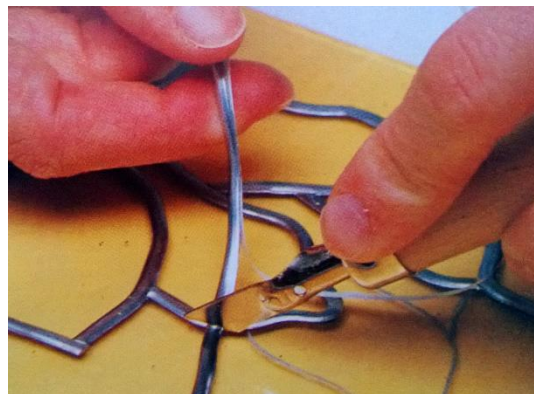
Fot. 87. Aplikacja taśmy ołowianej - Technika ołowiu samoprzylepnego
