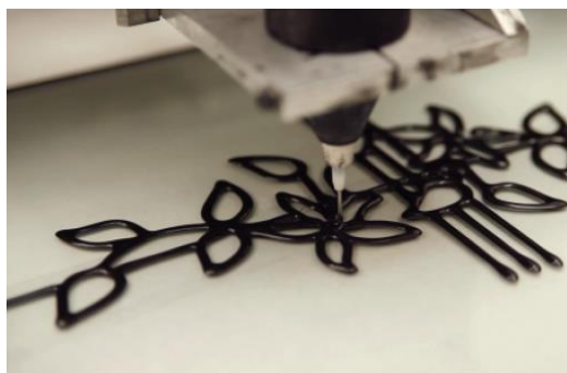
Fot. 96. Aplikacja maszynowa farby konturowej
