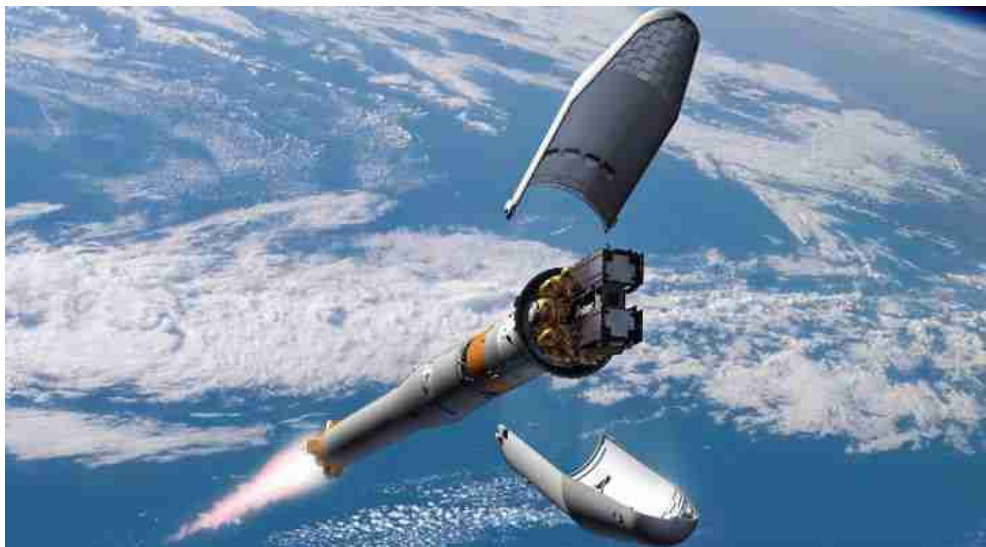
Rysunek 4.2: Rakieta odrzucająca owiewkę powyżej linii Karmana, źródło: [66]
